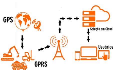
Suporta conexões 3G / 4G / WIFI / GPS de rastreamento / servidor CMS / servidor Amazon Cloud; permite monitoramento remoto em tempo real no cliente iOS e Windows; Com conexão WiFi e modo AP; O modo AP permite que o celular se conecte diretamente ao dispositivo para fácil visualização e configuração no terminal móvel pelo WebUI;
