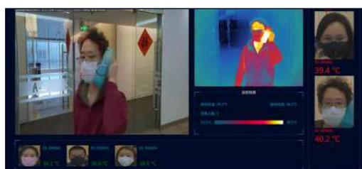
A câmera térmica usa algoritmos de IA que podem realizar o rastreamento automático de rostos e monitoramento de vários alvos.
