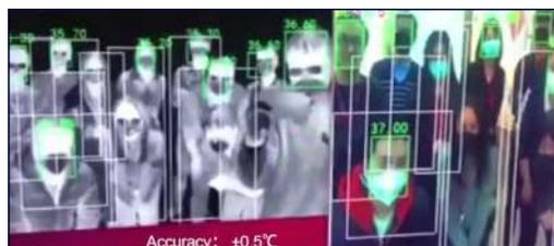
Algoritmo inteligente de calibração de temperatura patenteado com precisão de  $\pm 0,5^{\circ}\text{C}$ .
