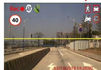
Reconhecimento de placa de velocidade (SSR) & alarme de velocidade excessiva
