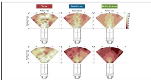
Diagrama real de níveis de pressão sonora por trás do veículo (expresso em dBA). Os resultados para a condição de montagem "ideal" são apresentados na linha superior, enquanto que aqueles para a condição de montagem "realista" são mostrados na linha inferior. Em ambas condições percebe-se a uniformidade superior da versão Ruído Branco sobre a versão Som Tonal ou Multi-Tom.
