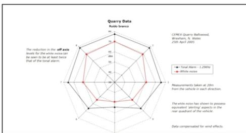
Medidas de Psicopercepção a 20 metros do veículo: O Alarme Ruído Branco demonstra oferecer um nível equivalente de alerta a um Som Tonal de 1.25 KHz com um nível de pressão sonora 8dB inferior. Níveis de Psicopercepção vantajosos em relação ao Alarme Tonal também são observados com trabalhadores portadores de protetores auditivos e pessoas com deficiências auditivas.
